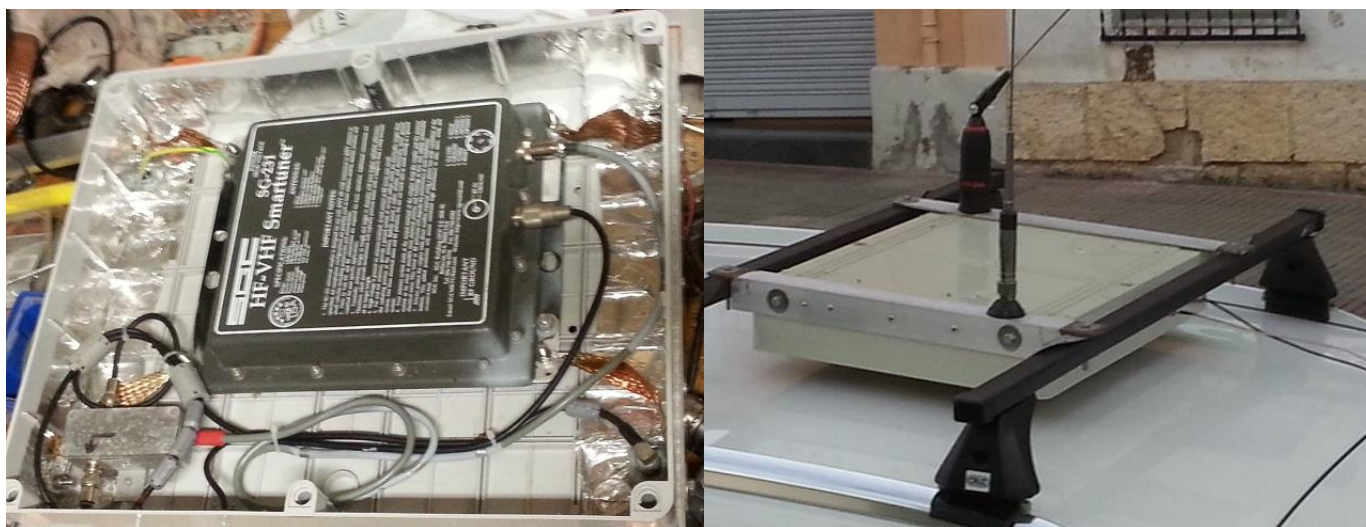
Fig. 11 i 12 Vista interior i exterior de la caixa amb l'acoblador
